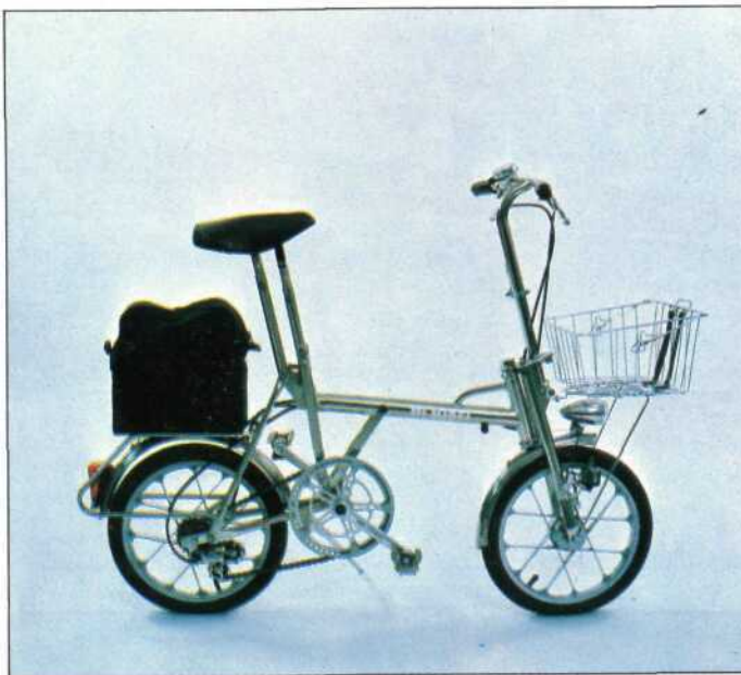
La bicicletta DI BLASI è disponibile anche con telaio in acciaio inossidabile AISI304 (mod. R50S)
